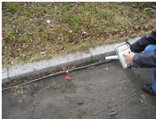
資図 2-1 ホットスポットの測定例 上左：NaI サーベイメータによる歩行サーベイ（時定数 3 秒） 上右：シンチレーションファイバーを用いた分布測定 下：当該部の様子
